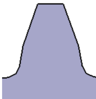
Fig. 2 Profilul evolvent al unui dinte dintr-un angrenaj cilindric
