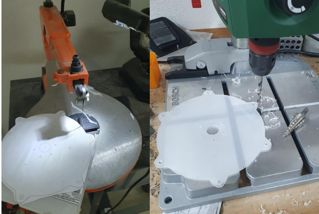
Fig. 12 Realizarea capacului prin metode clasice de prototipare
