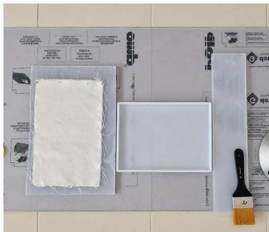
Fig. 1. Pregătirea plăcii de GFRP
