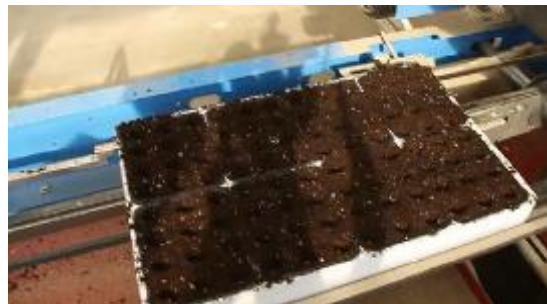
Fig.6 Captura de ecran in care este reprezentata o tava dupa procesul de presare a substratului in celulele tavii
