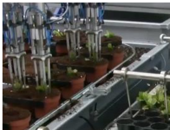
Fig.18 Captura de ecran in care se pot observa plantele in momentul in care sunt eliberate in ghivece.
