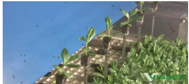
Fig.12 Captura de ecran in care se poate observa sistemul cu tije, care are rolul de a inalta plantele din celulele tavilor, urmand ca acestea sa fie analizate de camerele si senzorii sistemului.
