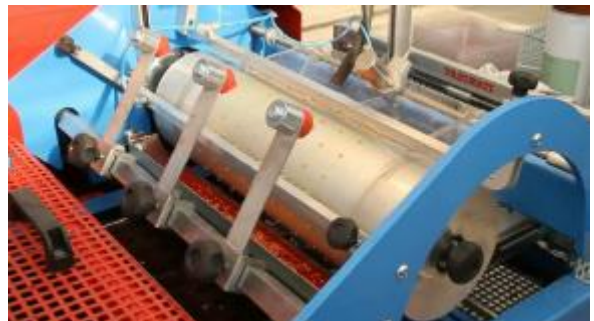
Fig.7 Captura de ecran in care este reprezentat sistemul de semantat de tip tambur
