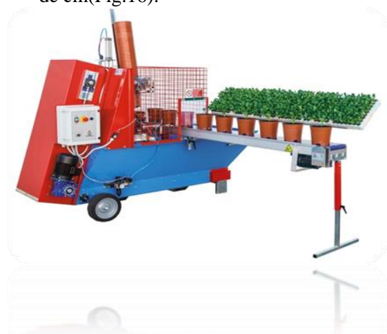
Fig.15 Imagine reprezentativa a sistemului de umplere a ghivecelor cu substrat
