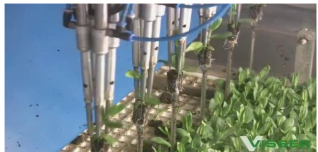
Fig.13 Captura de ecran in care se poate observa mecanismul care apuca planta si o duce catre tavile cu plantele deja sortate.
