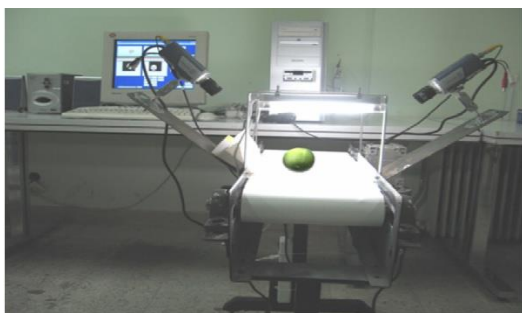
Fig.3. Dezvoltarea sistemului bazat pe camera Vision
