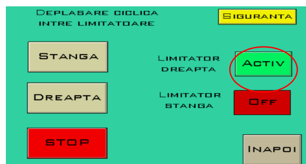
Figura 30. Limitatorul din partea dreaptă acționat
