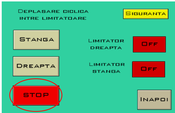
Figura 36. Acționare buton de oprire
