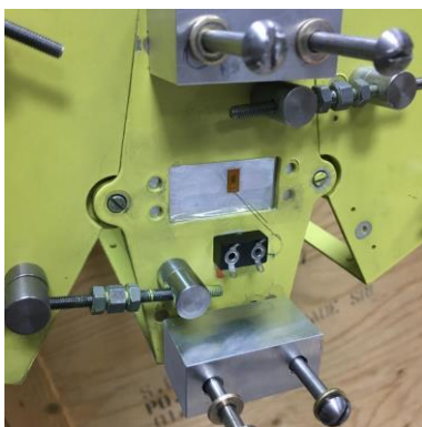
Fig. 13. Marcă tensometrică de compensare a temperaturii
