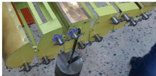
Fig. 4. Sistemul de acționare al aripii
