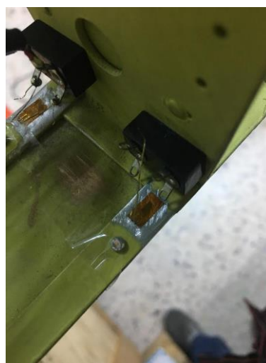
Fig. 11. Mărci tensometrice pe tronsonul median
