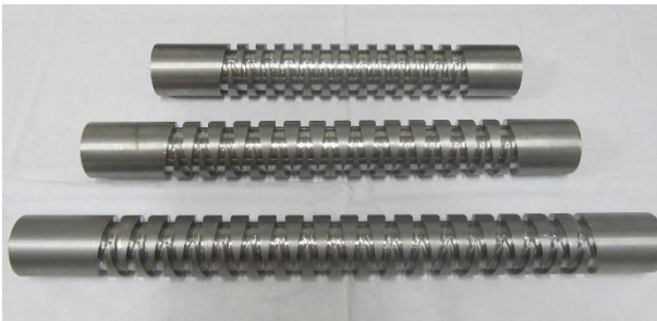
Fig.9 : Surubul cu schimbare autoamata a sensului
