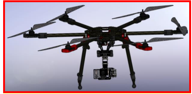
Fig. 17 Modelul CAD al hexarotorului (varianta echipată)
