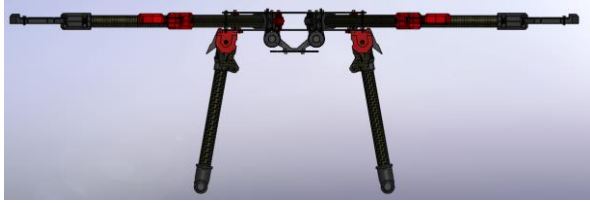
Fig. 12 Modelul CAD al hexarotorului (vedere frontală)
