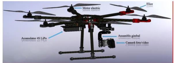
Fig. 18 Modelul CAD al hexarotorului (varianta echipată - continuare)
