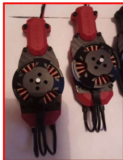
Fig. 20 Motoarele electrice fără perii montate pe capetele suport
