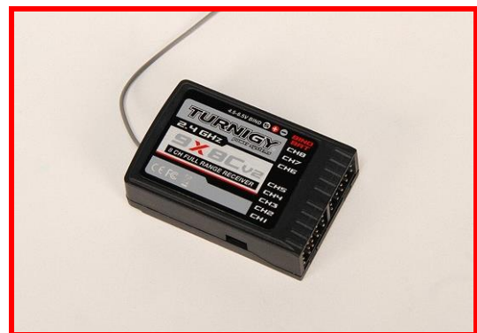
Fig. 39 Receptor pe 8 canale (Rx) Turnigy TGY 9x
