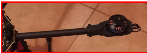
Fig. 22 Braț suport motor (de formă tubulară, realizat din fibră de carbon)
