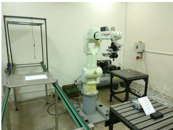
Fig. 1. Vedere de ansamblu robot KAWASAKI FS10E, controller, masă de lucru și panou de comandă
