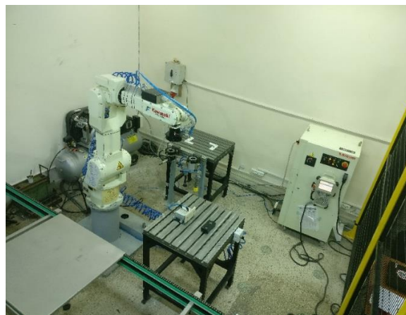
Fig. 1. Vedere de ansamblu celulă, robot KAWASAKI FS10E, controller, mese de lucru și conveior
