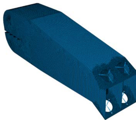
Fig. 17. Modelul după optimizarea parametrică
