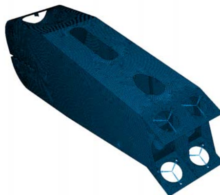
Fig. 20. Discretizarea cu elemente finite a braketului optimizat
