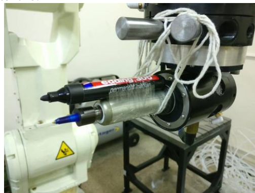
Fig. 4. Efectorul aplicației de scriere
