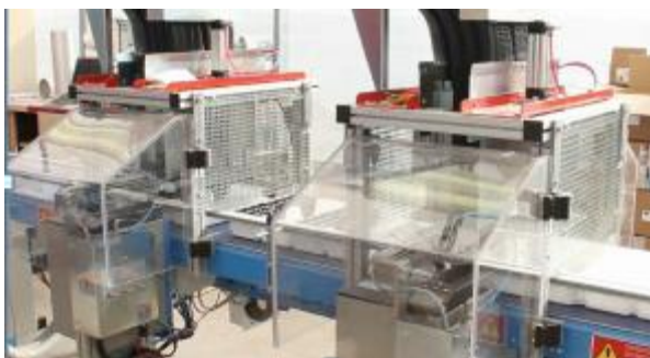
Fig.4 Captura de ecran in care se poate observa sistemul de dozare a tavilor
