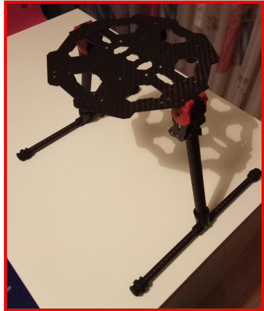
Fig. 23 Brațele care compun trenul de aterizare și placa inferioară (realizate din fibră de carbon)
