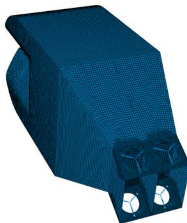
Fig. 14. Discretizarea brachetului cu elemente de tip shell a în CATIA
