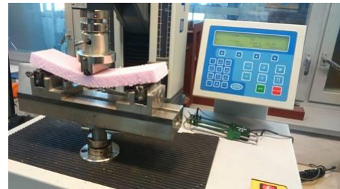
Fig. 3. Schema de testare a polistirenului
