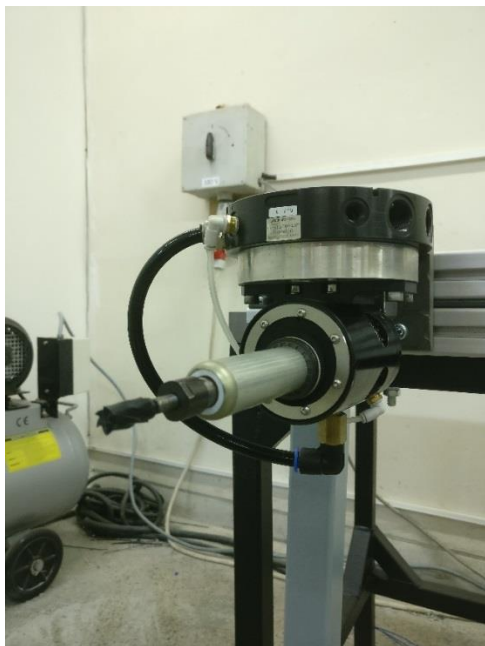
Fig. 5. Efector de frezare cu complianță
