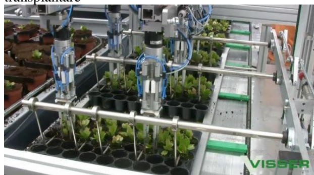
Fig.17 Captura de ecran in care se poate observa mecanismul care apuca plantele si le duce catre ghivecele umplute cu substrat.
