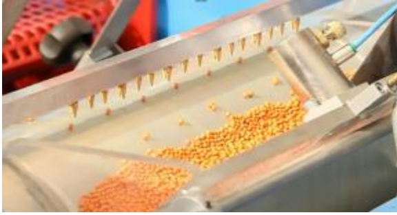
Fig.8 Captura de ecran in care este reprezentata tava vibratoare din care se dozeaza semintele
