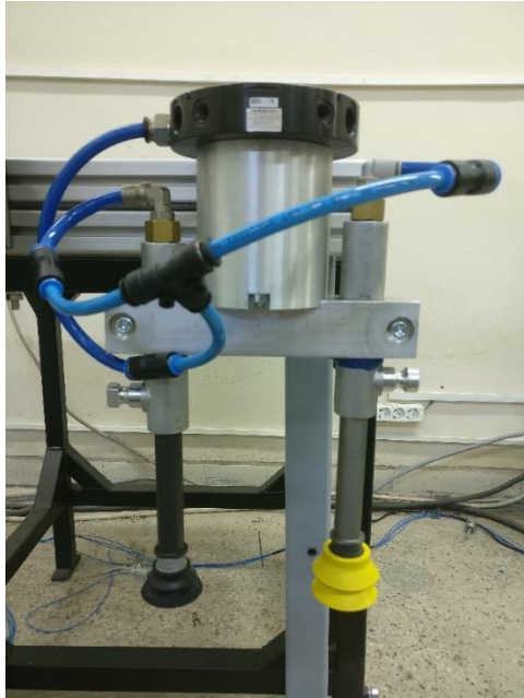
Fig. 4. Efector vacuumatic cu două ventuze
