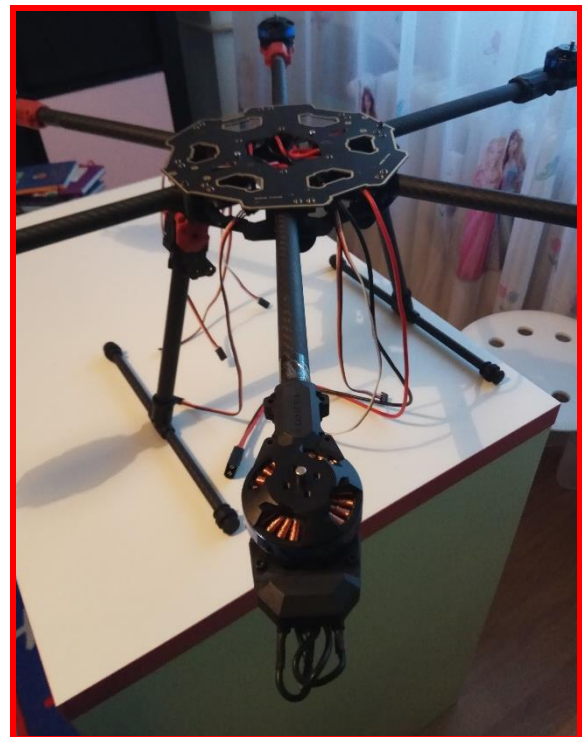
Fig. 24 Asamblarea celor două plăci, a trenului de aterizare și a brațelor suport motor
