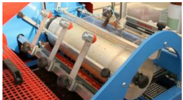
Fig.7 Captura de ecran in care este reprezentat sistemul de semant de tip tambur
