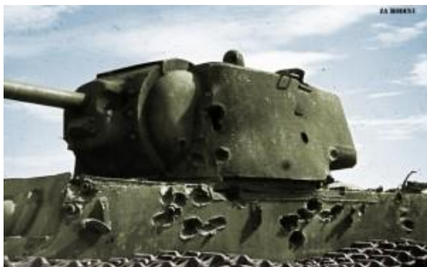
Fig. 1 Urme de lovituri antitanc, unele nepenetrând blindajul [1]
