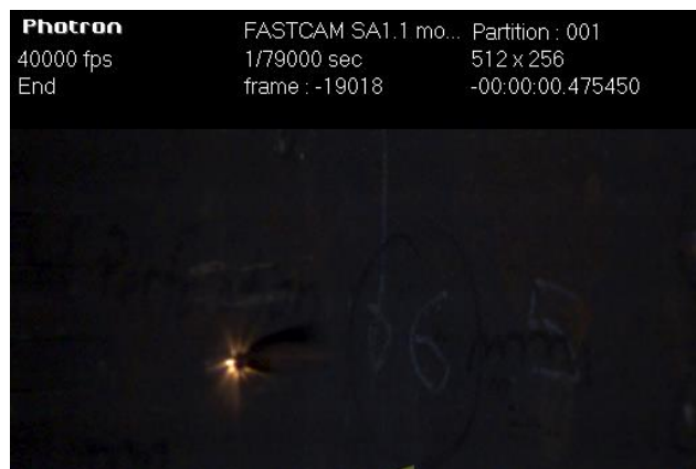
Fig. 19 Momentul impactului proiectil-placă - experimente din poligonul de tragere
