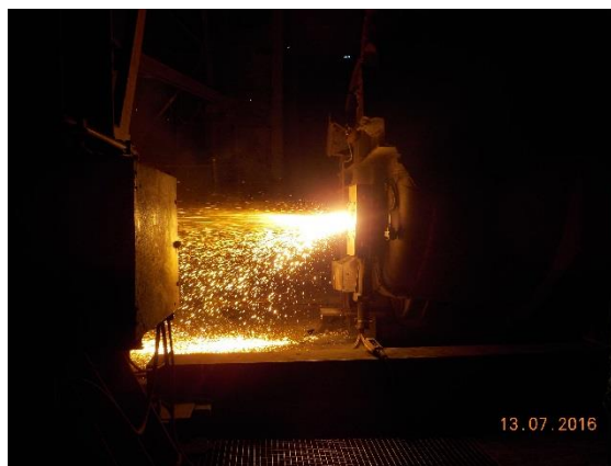
Fig.8. Curățarea orificiului de turnare al oalei
