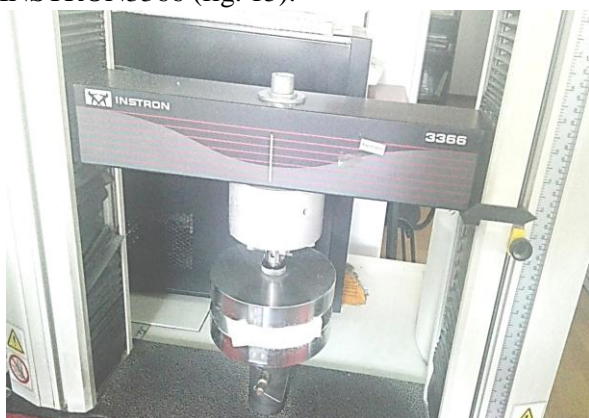
Fig. 15. Procesul de determinare a proprietăților spumei poliuretanică
