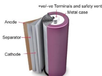
Fig. 1 Celula cilindrică (Johnson Matthey-Editia 3)
