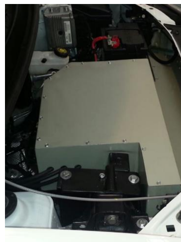
Fig. 2 Incinta pachet acumulatori 5,8 kWh
