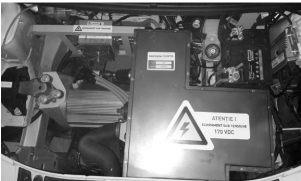
Fig. 8 Dispunere componente electronice zona incintă motor
