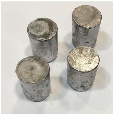
Fig. 6. Piesele înainte de deformare
