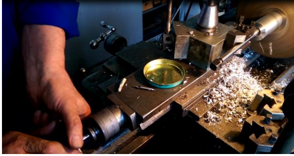
Fig. 17. Strunjire interioară de degroșare
