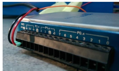
Fig. 29. Conexiune GND (negru) și Vs(roșu)
