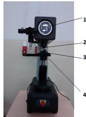
Fig. 5. Durimetru Innova Test 1- display; 2 - penetrator; 3 - masă; 4 -lupă
