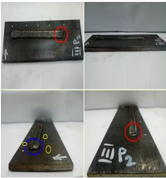
Figura 21. Aspectul cordonului depus ce a fost perturbat de un ventilator setat pe a doua treaptă de putere
