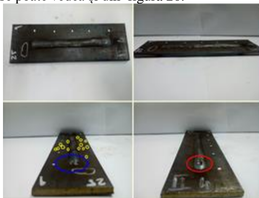
Figura 20. Imperfecțiuni observate în timpul experimentului
