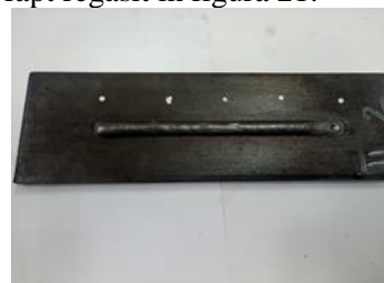
Figura 21. Aspectul geometric al cordonului II-2
