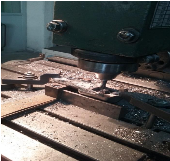
Fig.6. Frezarea semimodelului inferior
