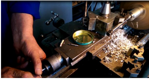
Fig. 17. Strunjire interioară de degroșare
