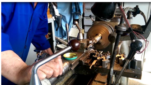
Fig. 12. Strunjire degroșare \phi 36
