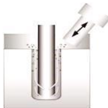
Fig 6. Scufundarea sonotrodei vibratoare în dielectric
