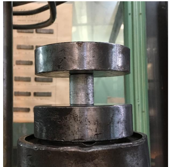
Fig. 7 Poziționarea piesei în vederea deformării plastice pe presă
