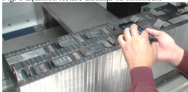
Fig. 9 Acumulator format din 39 de celule supus testării
