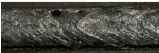
c) Aspectul cordonului depus sub influența celor două ventilatoare funcționând în treapta întâi de putere.
