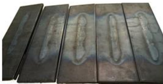
Figura 22. Ondulațiile simetrice ale câmpului de influență termică observate pe spatele probelor după operația de sudare.
