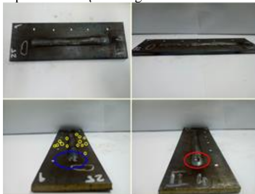
Figura 20. Imperfecțiuni observate în timpul experimentului
