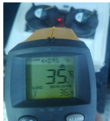
Fig. 26. Măsurarea temperaturii pe placa caldă
