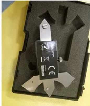
b) Leră pentru măsurarea cordonului Figura 5. Instrumente de măsură.
