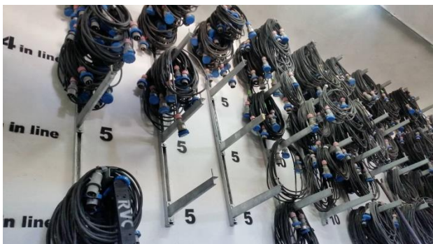
Fig.11.Sortarea cablurilor in functie de lungimea lor
