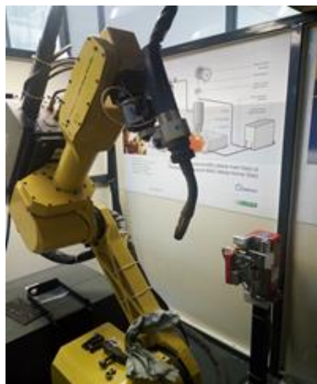
Figura 1 . Robotul de sudare FANUC ArcMate100iBe
