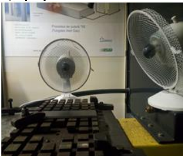
Figura 11. Două ventilatoare ce funcționează simultan, unul ce va împinge aerul pe aceeași direcție cu viteza de sudare iar celălalt va împinge aerul pe o direcție perpendiculară cu viteza de sudare.
