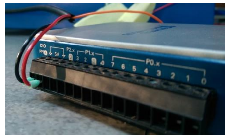
Fig. 29. Conexiune GND (negru) și Vs(roșu)
