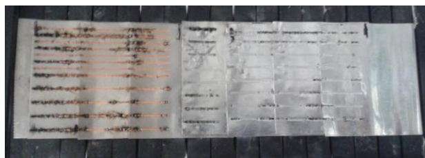
Fig. 7 Asamblare eșantion testare sudura celule
