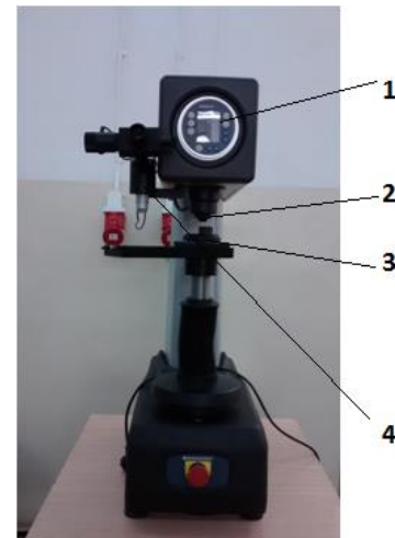
Fig. 5. Durimetru Innova Test 1- display; 2 - penetrator; 3 - masă; 4 -lupă
