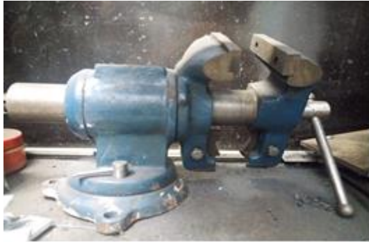
Figura 3 . Menghina utilizată pentru obținerea gradelor de deformare a duzelor
