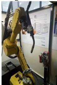
Figura 1. Robotul de sudare MAG FANUC ArcMate 100iBe.
