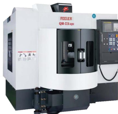
Fig. 2. Centru de prelucrat vertical Feeler QM-22 Aapc
