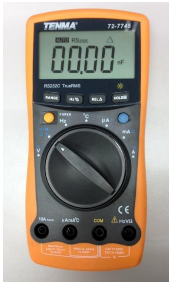
Fig. 19 Aparat de măsură Tenma 72-7745
