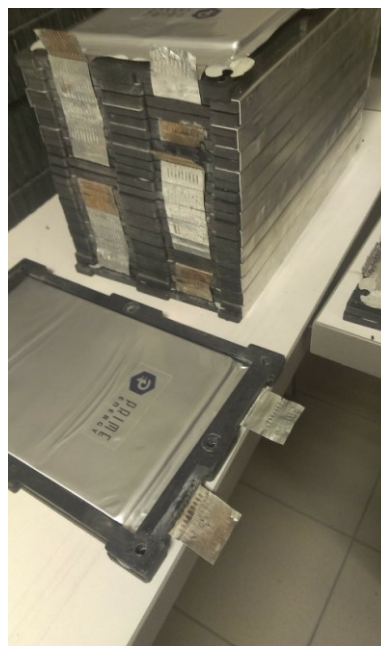
Figura 2.4.9 Varianta 4 de asamblare acumulator
