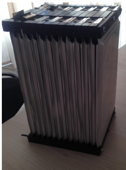
Figura 2.4.2 Varianta 1 de asamblare acumulator
