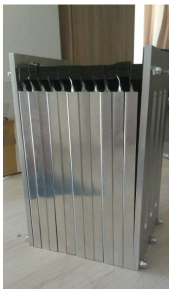
Figura 2.4.5 Varianta 2 de asamblare acumulator
