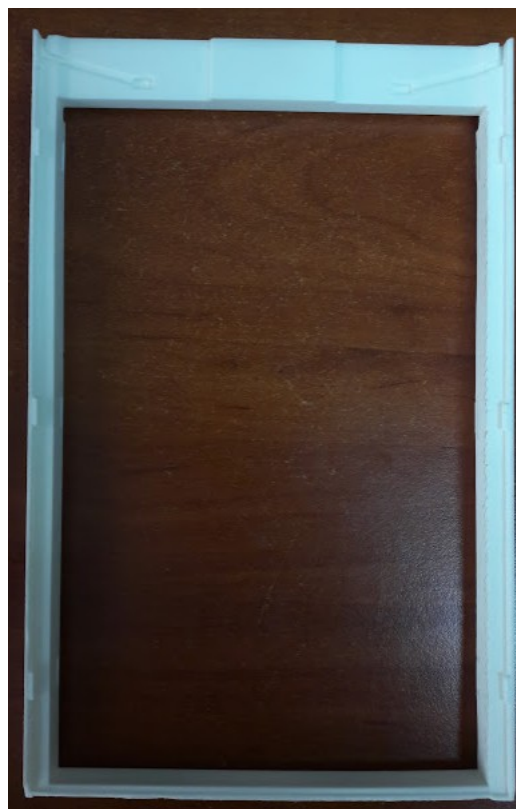
Figura 3.1. Rama printată pe imprimantă 3D
