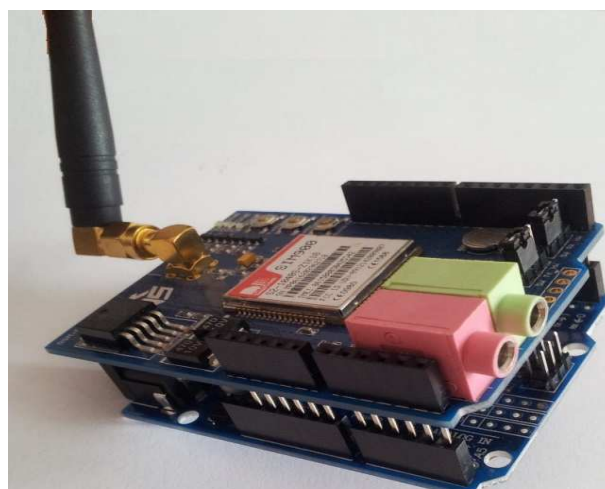
Fig. 11. Interfațarea plăcii Arduino cu shield-ul GSM
