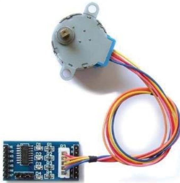
Fig. 7. Motor pas cu pas folosit pentru actionarea sistemului
