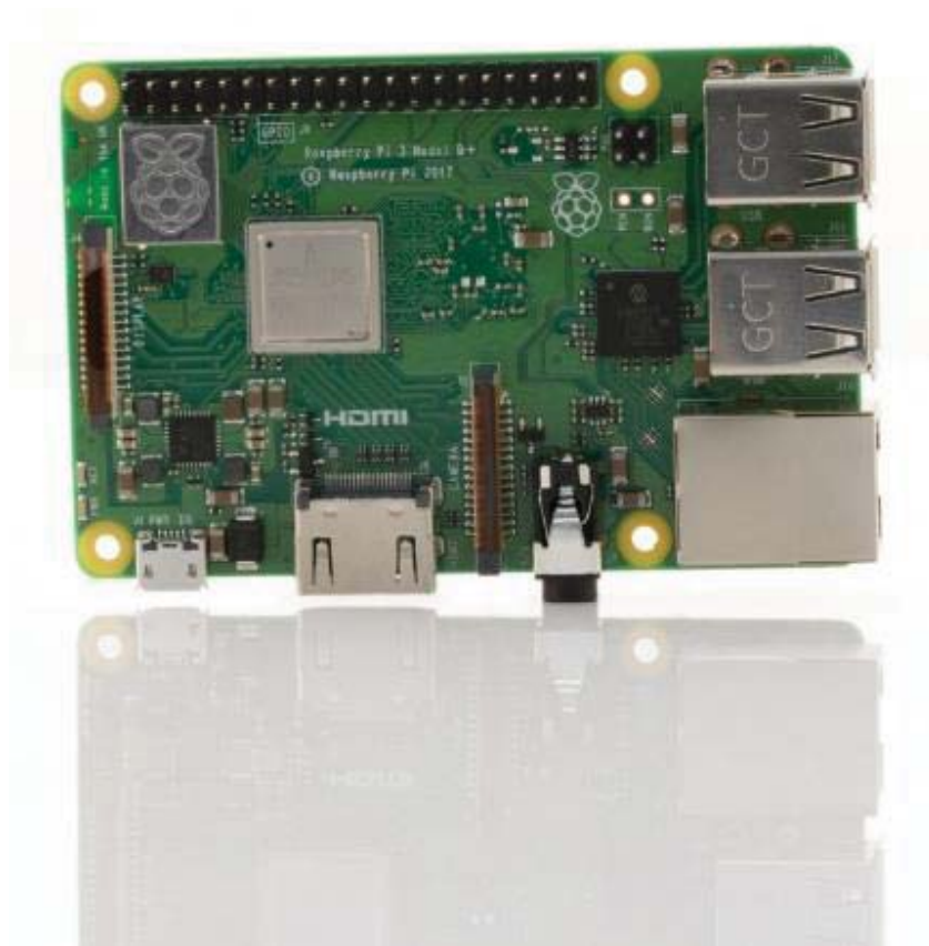
Fig. 8. Raspberry Pi 3 Model B+ folosit pentru sistem
