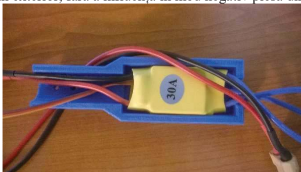
Fig. 1. Piesă cu ESC-ul în interior
