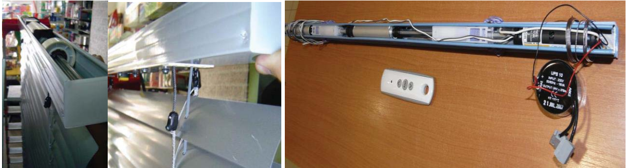
Fig. 1. Sistem de strângere și desfacere a jaluzelei cu mecanism tip scripete cu fir [1]
