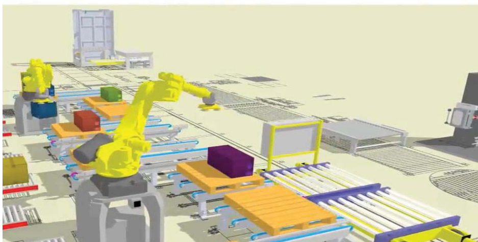
Fig. 3. Robotul depune obiectele de același tip pe paleți. Paleții sunt preluați de AGV[2]
