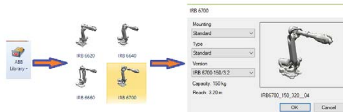
Fig. 5. Secvență integrare robot ABB IRB 6700 în aplicație
