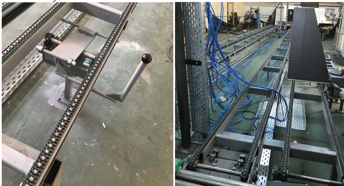
Fig. 13 Opritor manual si conveioarele in timpul testelor din atelier
