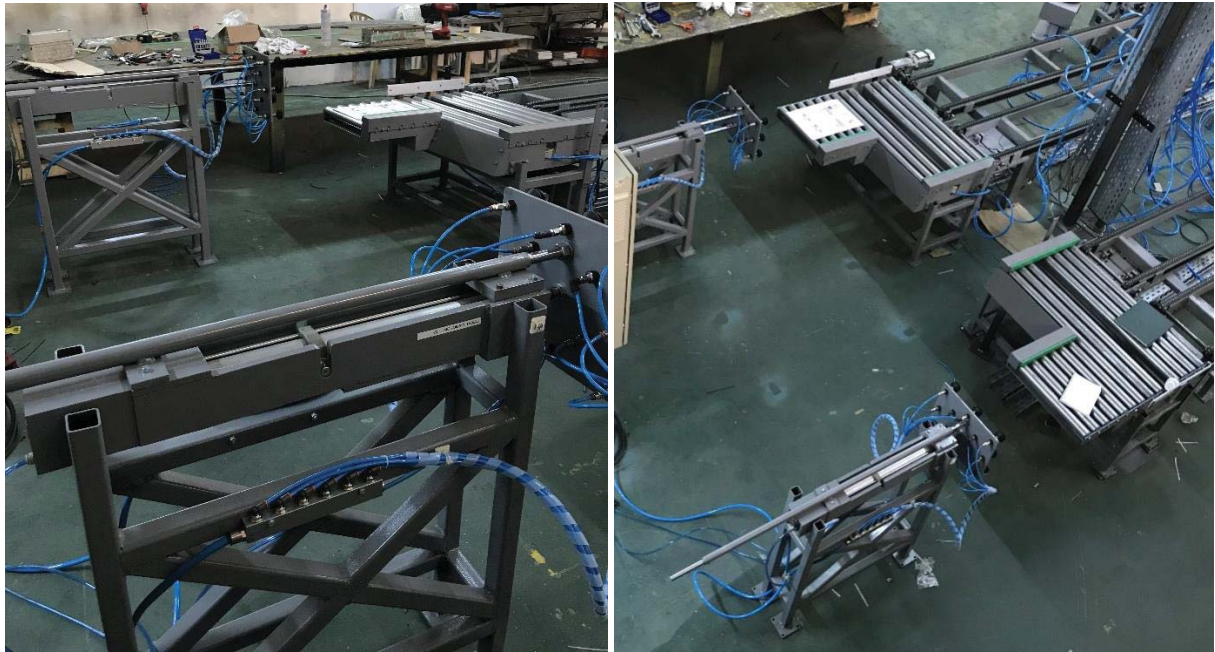
Fig. 14 Sistemele de incarcare/descarcare si posturile de transfer din fata
