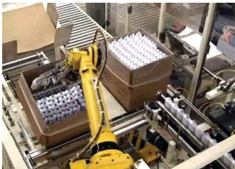
Fig. 2 Aplicație pentru împachetarea recipientelor din plastic [2]
