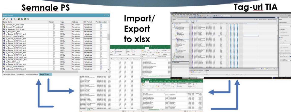
Fig. 6 Maparea semnalelor inre Process Simulate si TIA Portal folosind export/import si editarea valorilor in Microsoft Excel
