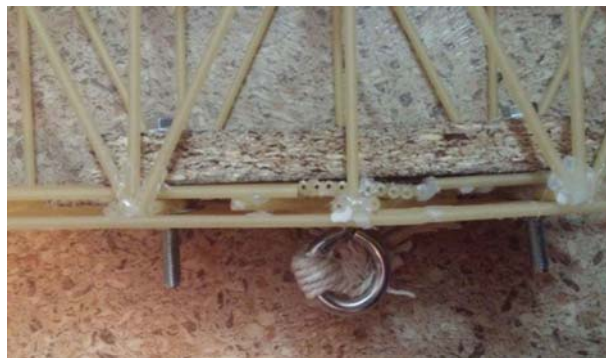
Fig. 9 Sistemul de încărcare a podului
