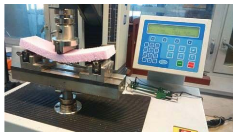
Fig. 2. Testarea la încovoiere a polistirenului extrudat
