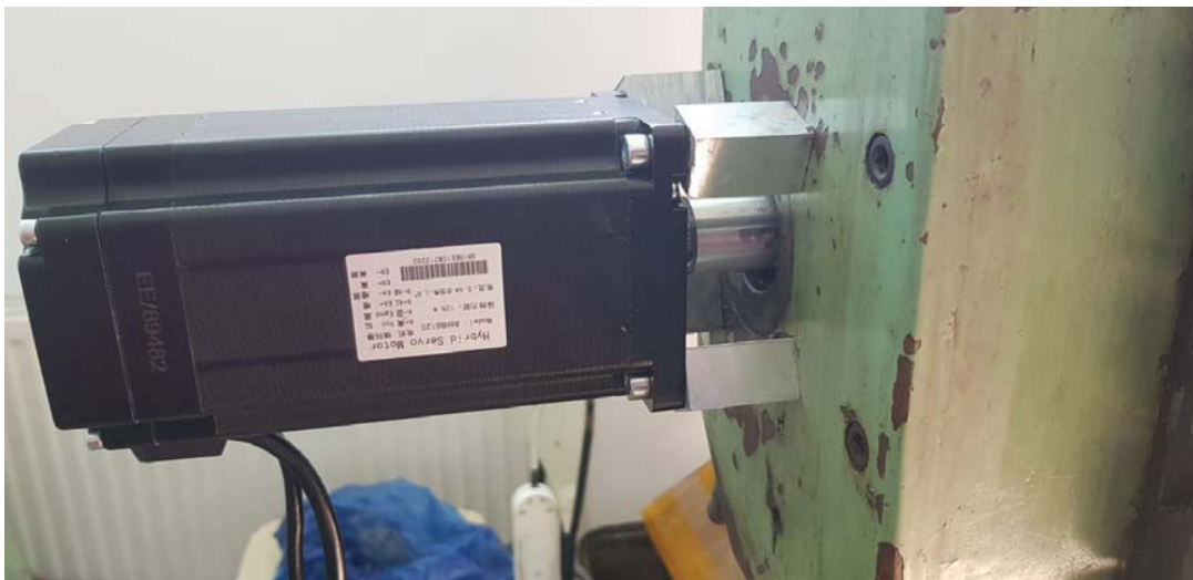
Fig 10 – Motorul montat pe mașina FN32 cu distanțierele
