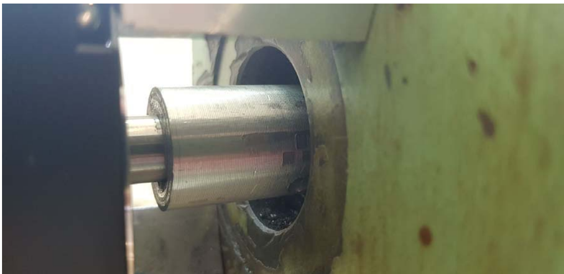
Fig 12– Bucșă montată pe axul șurubului
