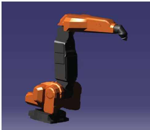
Fig.6 – Modelul CAD al robotului de vopsire
