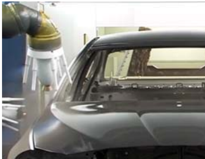
Fig.18 – Proces de vopsire robotizată[9]
