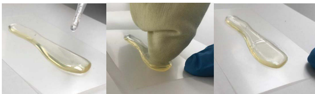
Fig. 15. Grad de polimerizare insuficient – test acetonă
