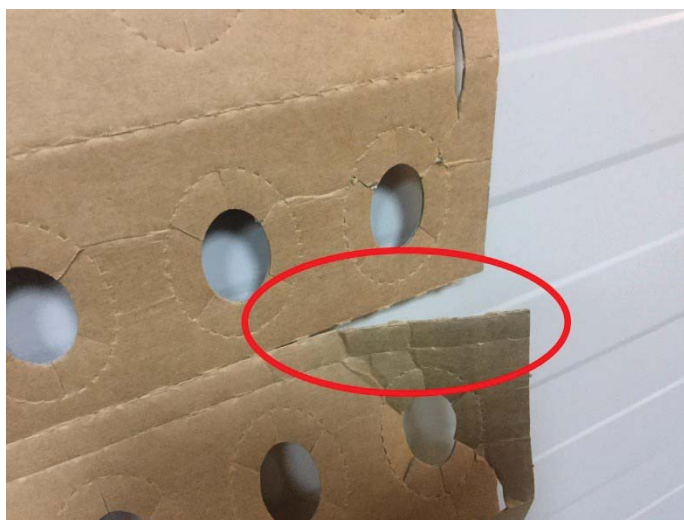
Fig. 8. Neconformități semnalate de client la formarea cofrajului
