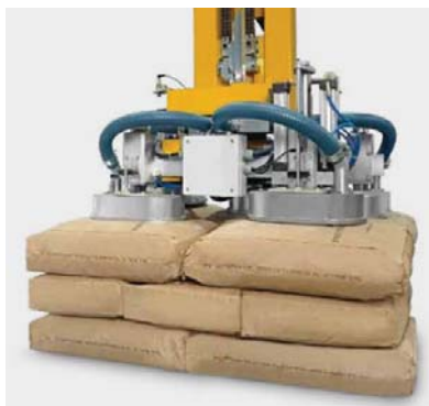
Fig. 7. Capul de încărcare cu configurația discurilor de aspirație de 5x1 [1]
