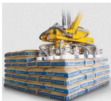
Fig. 9. Capul de încărcare cu configurația 5x2 [2]
