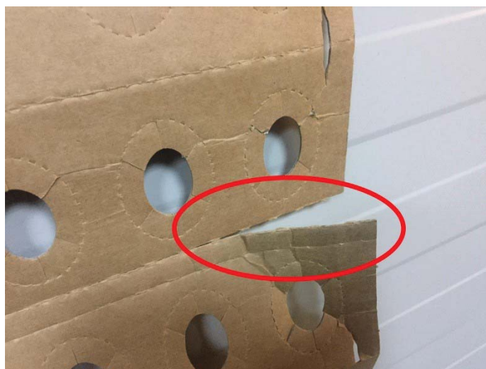
Fig. 8. Neconformități semnalate de client la formarea cofrajului
