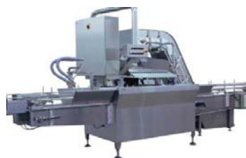
Fig. 5. Echipament de îmbuteliere a murăturilor în borcane [3]
