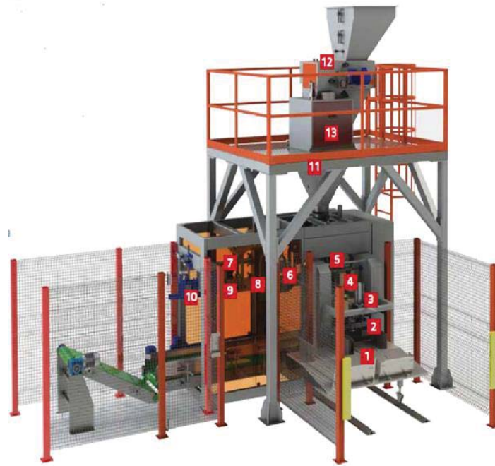
Fig. 1. Modulul de linie de ambalare IABA 600/S [1]
