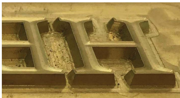
Fig. 5. Clișeu cu relief pentru folio
