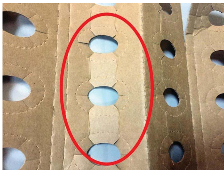
Fig. 7. Neconformități semnalate de client la formarea cofrajului
