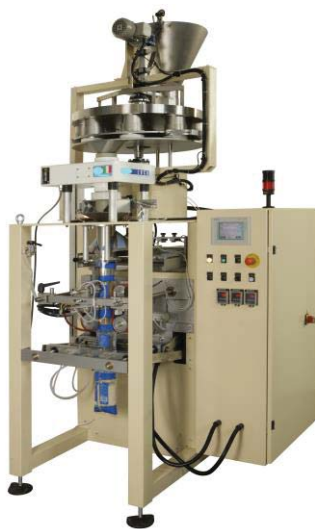
Fig. 2.1. Mașină verticală de ambalat în pungi tip pillow sau gusseted [1]
