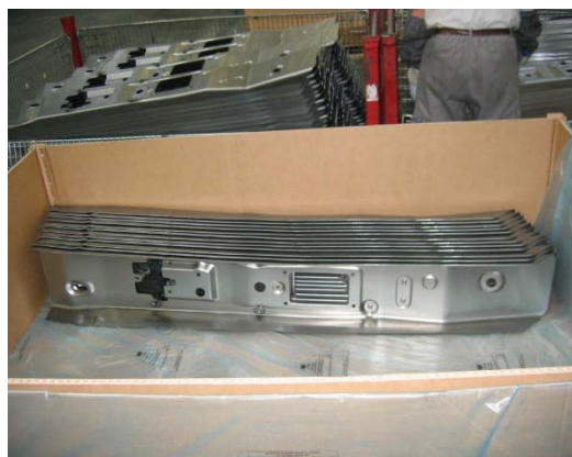
Fig.14 Piese conditionate pe cant (200 pcs -3E)
