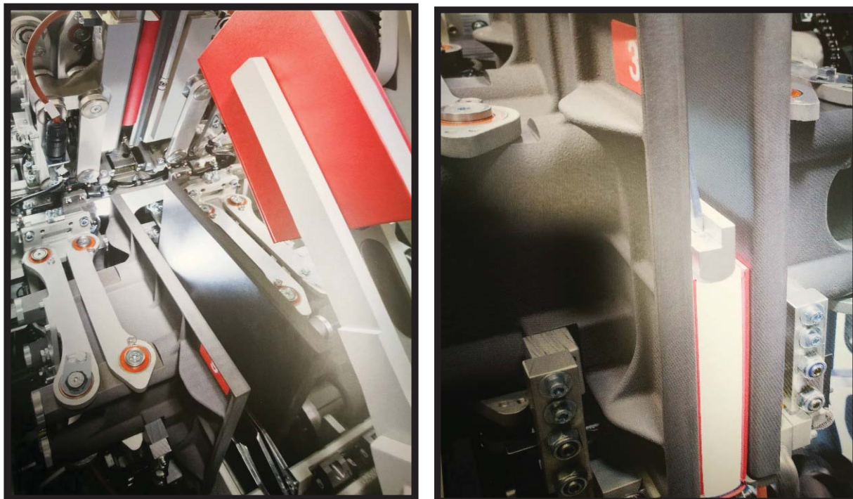
Fig. 9. Grupul de formare a cărții și de presare
