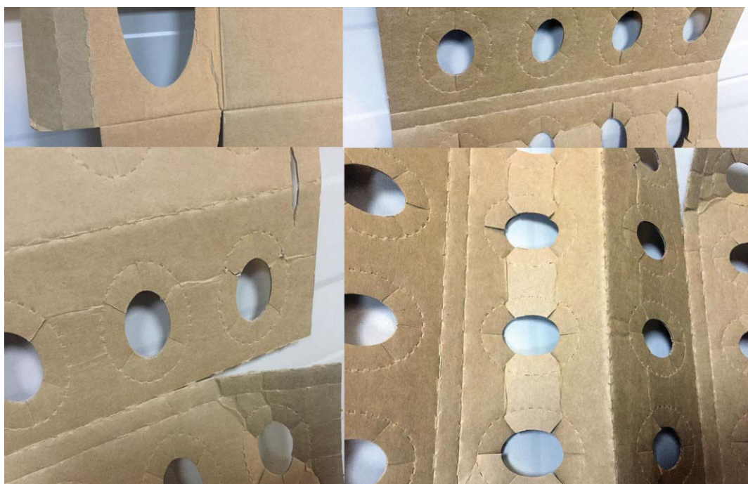
Fig. 5. Neconformități semnalate de client la formarea cofrajului
