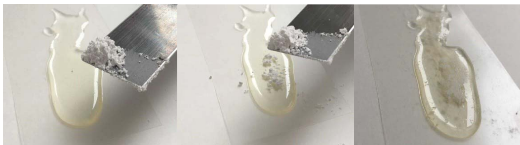
Fig. 16. Grad de polimerizare insuficient – test cu praf de talc
