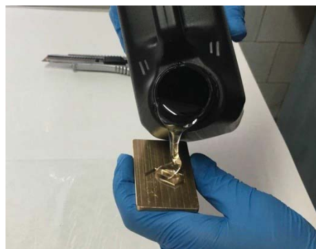
Fig. 11. Turnarea materialului fotosensibil
