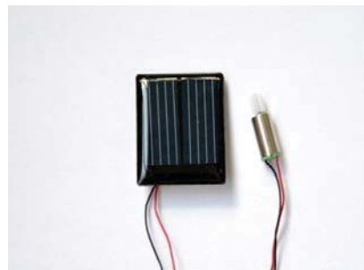
Fig. 8. Exemple celule fotovoltaice
