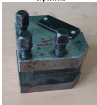
d) dispozitivul interschimbabil cu partea activă în V
