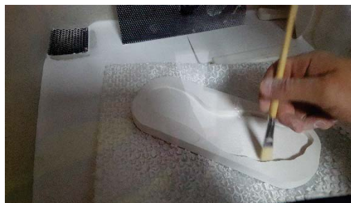
Fig.22. Îndepărtarea pulberii din golurile existente
