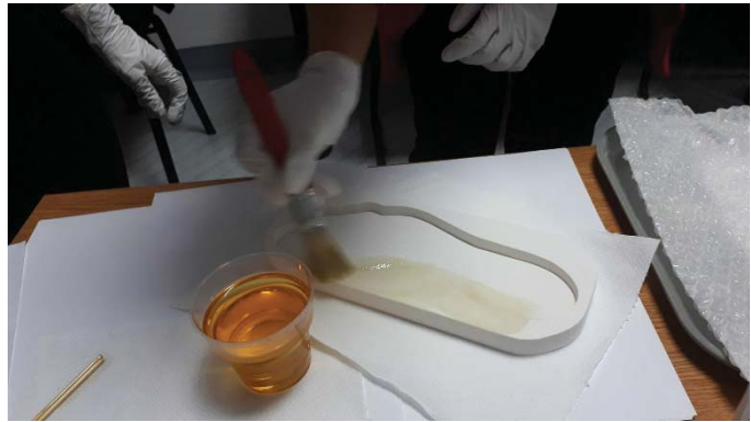
Fig. 24. Infiltrare cu material
