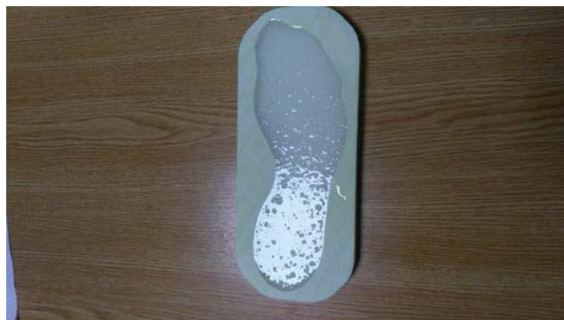
Fig. 27. Turnarea siliconului în matriță
