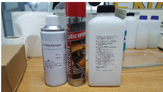
Fig. 25. Demulanți și siliconul folosit
