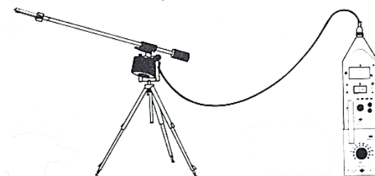
Fig. 1. Câmpul de măsurare a izolării zgomotului de fond folosind un sonometru și un braț de microfon rotativ [3]
