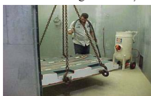
Fig.16. Sablarea și prelucrarea prin stropire
