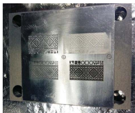
Fig.7.1. Partea mobilă a matriței
