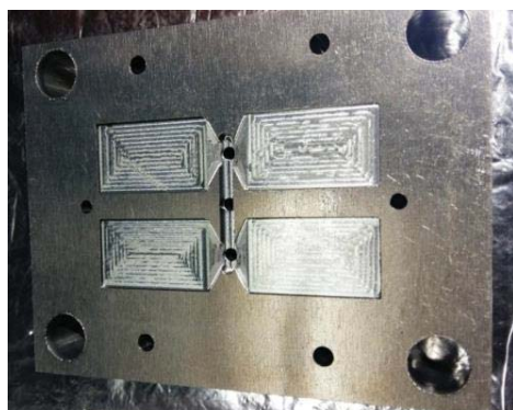
Fig.6.1. Partea fixă a matriței
