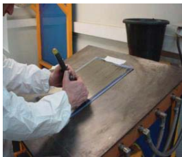
Fig.12. Fabricarea și controlul filmului de transfer
