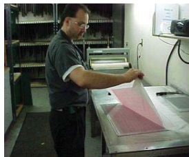
Fig.12. Fabricarea și controlul filmului de transfer
