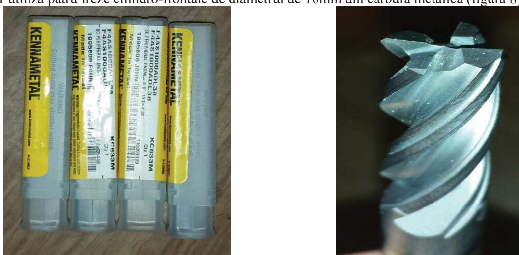
Fig. 8. Freza cilindro-frontală utilizată în cadrul experimentelor
