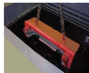
Fig.15. Imersarea matritei in baia de acid
