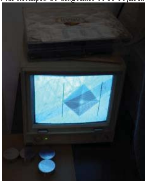
Fig. 7. Exemplu de diagonale obținute la determinarea durității unei piese
