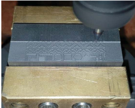
Fig.18. Electrodele în timpul prelucrării
