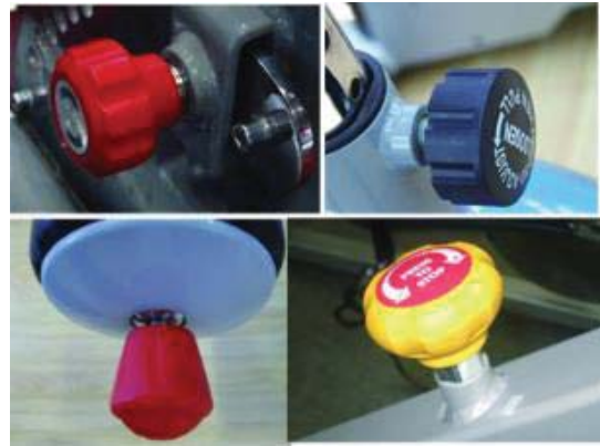
Fig. 18. Mecanism de tip șurub cu arc/ pull lock [4]
