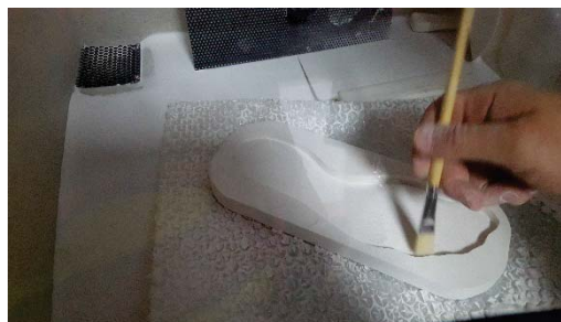
Fig.22. Îndepărtarea pulberii din golurile existente
