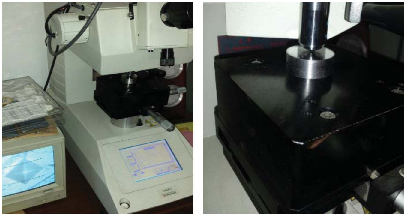
Fig. 6. Determinarea durității cu durimetru HMV Shimadzu
