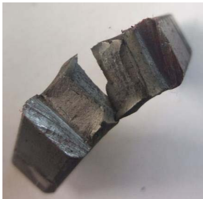
Fig. 8 Încercarea prin șoc a epruvetelor din E295
