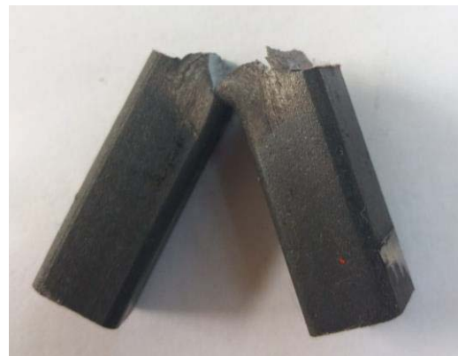
Fig. 8 Încercarea prin șoc a epruvetelor din E295
