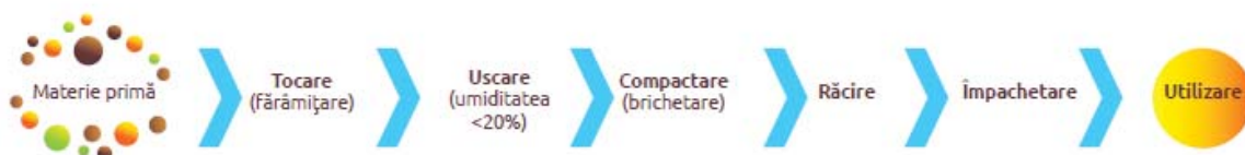
Fig. 1. Procesul tehnologic general de brichetare [1].
